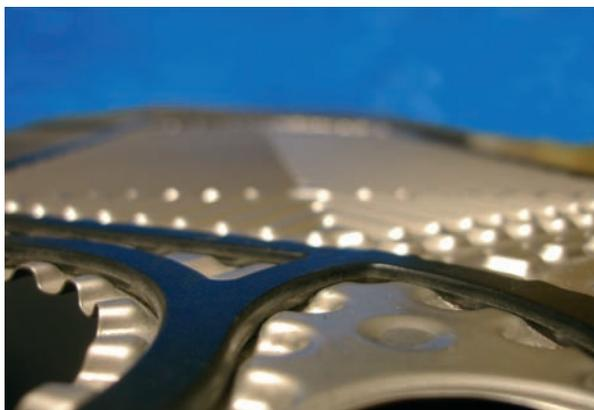
Der UniGasket Hochleistungswärmeüberträger besteht aus einer Anzahl geprägter, mit Spezialdichtungen versehener Edelstahlplatten, die gemäß der zu erfüllenden Anforderungen ausgewählt wurden. Unterschiedliche Prägemuster und Presstiefen bewirken hochturbulentes Fließverhalten und maximalen Selbstreinigungseffekt sowie höchstmögliche Wärmeübertragung. Die Platten werden mittels Spannbolzen zwischen der Gestell- u. Druckplatte gegen Dichtungen aus NBR, EPDM oder VITON gepresst.
